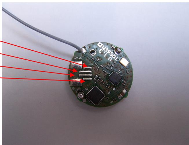
**+ LED:** Ausgang für Kontroll-LED (gegen GND); Vorwiderstand mit 680Ohm ist bereits integriert
