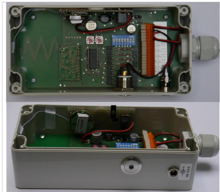
Der Funk-Ruf-Wandsender FRT-WS 8 dient der Funkübertragung von 8 Befehlen, die auf einem Funkruf-Empfänger optisch und/oder akustisch zur Anzeige gebracht werden oder auch bis zu 8 Relais schalten. Die 8 Eingänge sind Optoentkoppelt und können über einen Dipschalter einseitig mit der Versorgungsspannung verbunden werden.
