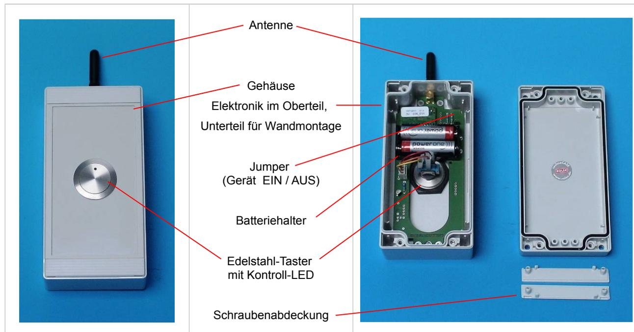
Der Funk-Ruf-Wandsender FRT-WS 1 dient der manuellen Funkruf-Auslösung, die auf einem oder mehreren mobilen oder stationären Funkruf-Empfängern optisch und/oder akustisch zur Anzeige gebracht wird oder über eine serielle Schnittstelle einem übergeordneten System zur Verfügung gestellt wird.
