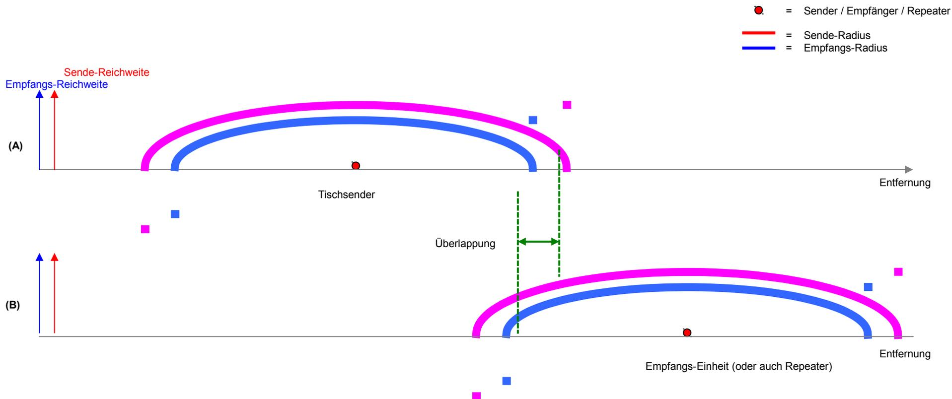
(A) und (B) zeigt die typischen Sende- und Empfangsreichweiten des Tischsenders (A) und einer Empfangs-Einheit (B).
