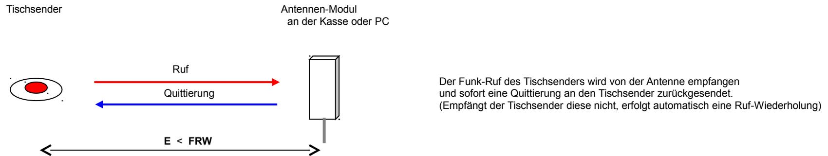
Beispiel 2: Entfernung „E“ von Tischsender zu Antenne an der Kasse ist außerhalb der Funkreichweite „FRW“, dann wird ein Repeater auf etwa halber Entfernung zwischen Tischsender und Antenne gesetzt
