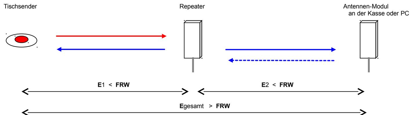
Bei noch größeren Entfernungen oder in funktechnisch schwierigen Objekten können mehrere Repeater kaskadiert werden. Da die Objektgegebenheiten immer verschieden sind, muss bei Bedarf eine objektspezifische Projektierung erfolgen. Bitte fragen Sie an.
