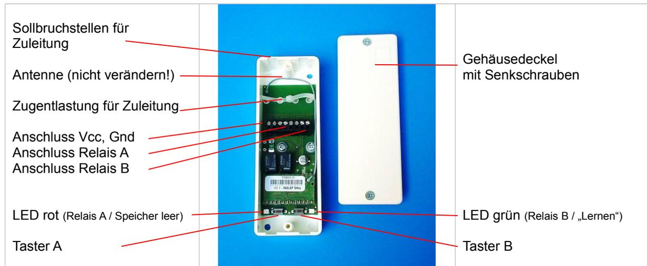
Der 2-Befehl-Empfänger FRT-RX-2 schaltet je nach Zuordnung das Relais A bzw. B für jeweils ca. 2 sec., wenn gültige Funkbefehle eines eingelernten Senders wie z.B. FRT-Mini oder FRT-HS2 empfangen wurden. An dem Empfänger können bis zu 10 Sender eingelernt werden.
