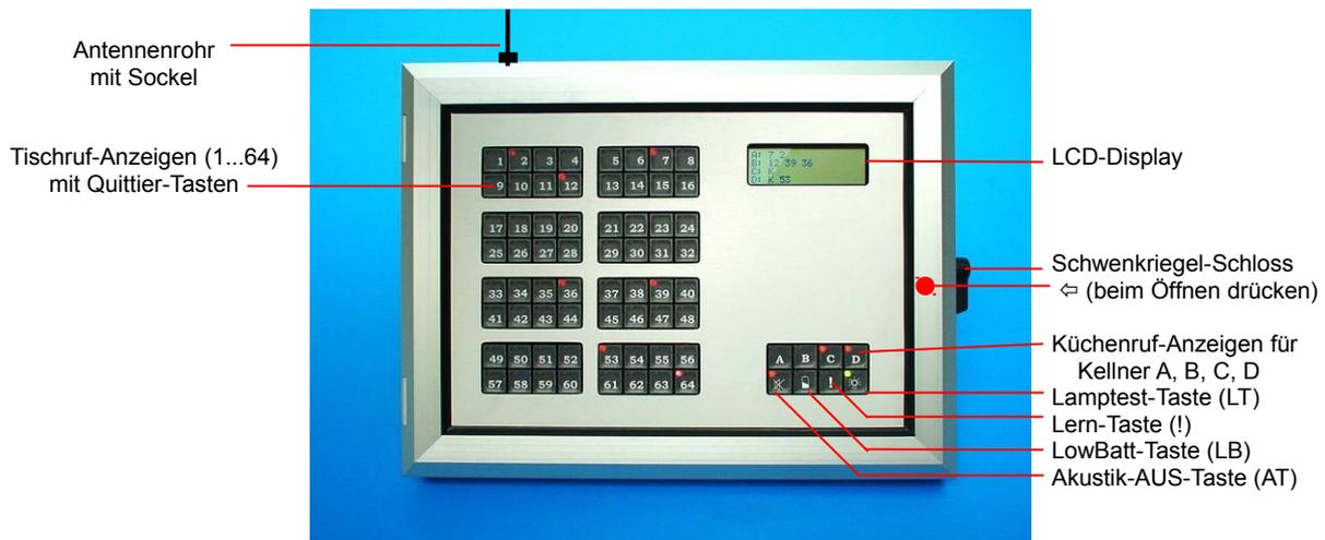
**Tableau öffnen:** abschließbaren Schwenkriegel 90° nach vorn drehen; zum Verschließen: 90° nach unten.
